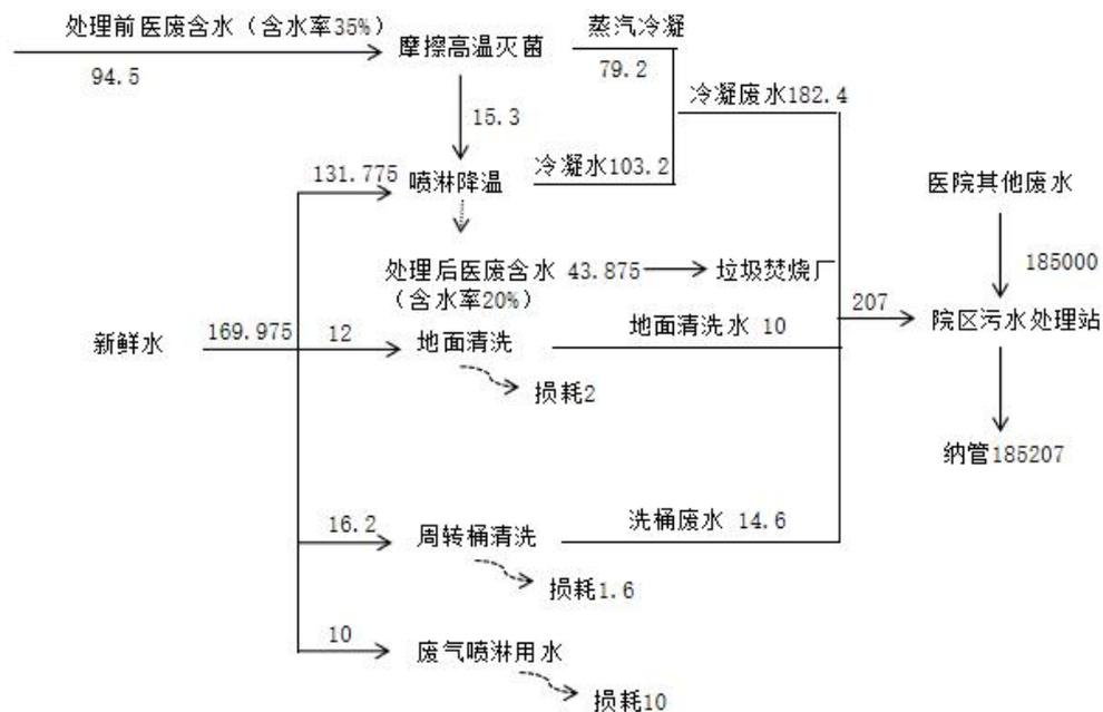
图 2-1 项目水平衡图 单位 t/a
