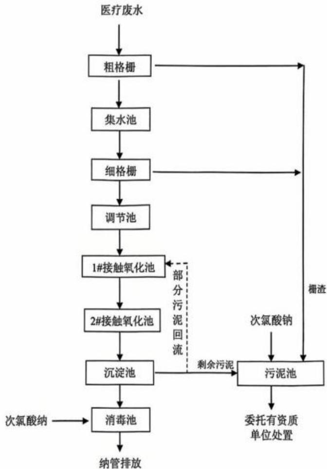
图 4-1 院区污水处理工艺流程图
